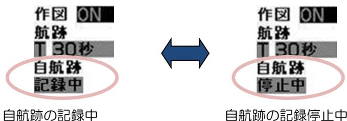
航跡の記録を開始するには、カーソルを左下表示部の自航跡の停止中に合わせて、**決定**キーを押します。航跡の記録を停止するには、カーソルを左下表示部の自航跡の記録中に合わせて、**決定**キーを押します。記録を再開するには、カーソルを停止中に合わせて、**決定**キーを押します。ファンクションキーに、[自航跡記録] 機能を設定すると、キーを押すごとに記録と停止が切り替わります。（「2.21 ファンクションキーの使い方」参照）
