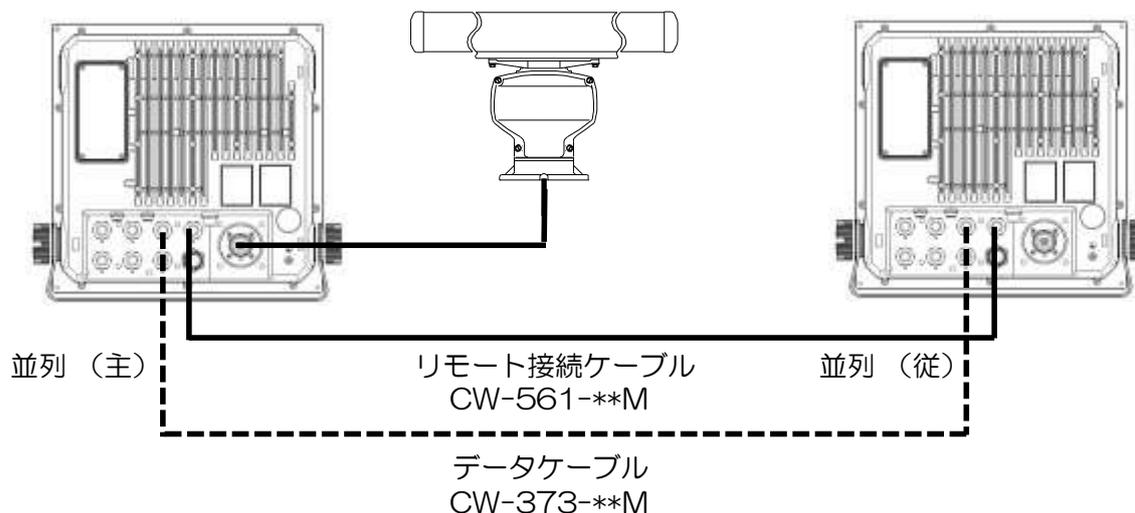
クロス：2式のレーダーシステムを、リモート接続ケーブルとデータケーブルで接続します。
