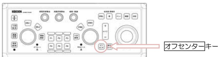
**トラックボール**/**ジョイスティック**の場合は、右上表示部のオフセンター**OFF**表示にカーソルを移動し、**決定**キーを押します。
