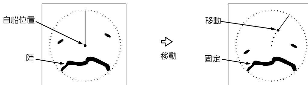
**N UP<sub>TM</sub>** または **C UP<sub>TM</sub>** 選択時、自船位置は船首線の方向の反対に移動し、真運動動作を開始します。自船位置が画面の真中まで移動したとき、自船位置は船首線の反対方向に戻ります。
