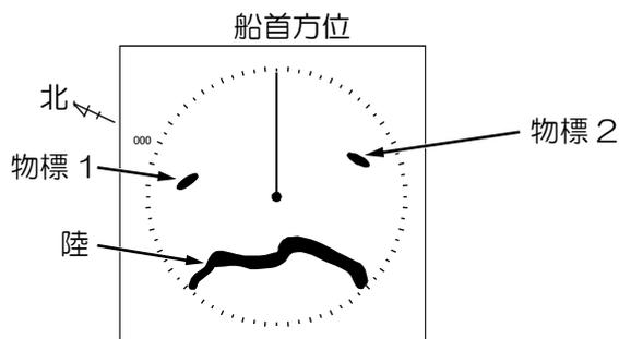
船首方位信号が入力されているとき、ヘッドアップは方位安定表示の安定化ヘッドアップモードとして動作します。(STAB HUP)
