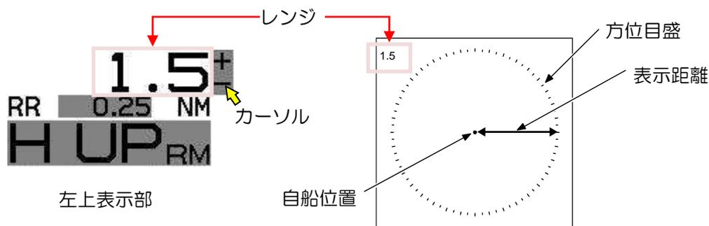
距離レンジは、[トラックボール]/[ジョイスティック]を操作して、左上表示部の距離レンジ表示の右隣の[+]または[-]印上にカーソルを移動し、[決定]キーを押すことでも切替えができます。
