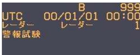
警報試験表示が表示されます。警報ブザー音が鳴らない場合は、操作部の故障が考えられます。
