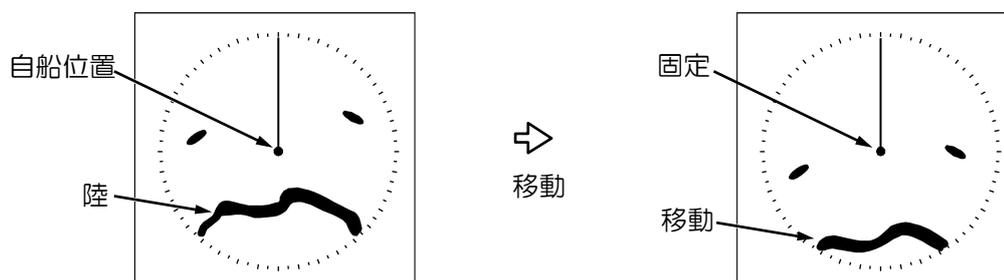
真運動 (TM)：画面上の自船は速力、潮流などにより移動します。動かない物標は固定している画面
