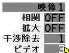
**トラックボール**/**ジョイスティック**の場合は、右上表示部のビデオ表示の右側ウィンドウにカーソルを移動し、**決定**キーを数回押して **1**、**2**、**3**、**4**、**5** を選択します。
