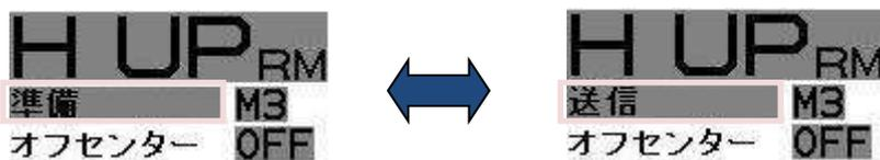
トラックボール/ジョイスティックの場合は、左上表示部の準備表示にカーソルを移動し、決定キーを押します。
