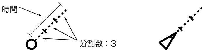
[安定化矢印表示]: 本設定は、自船ベクトルの先端に対地安定、または対水安定モードを表す矢印表示の表示/非表示を切替えます。
